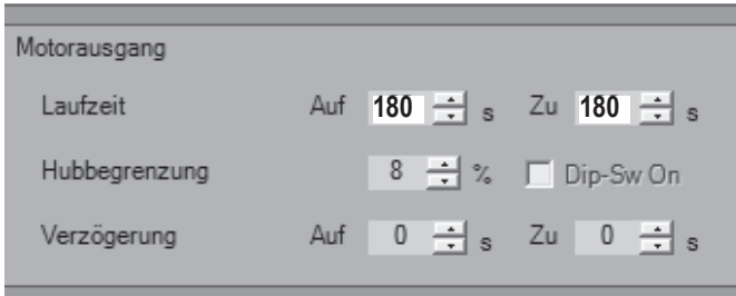
Abb.: Konfigurationsoberfläche Lüftung, Kanal 1, Motorausgang
