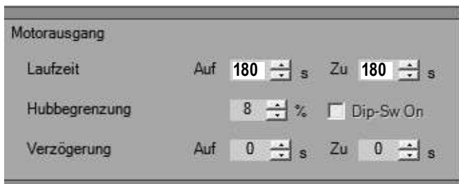
Abb.: Konfigurationsoberfläche Lüftung, Kanal 1, Motorausgang
