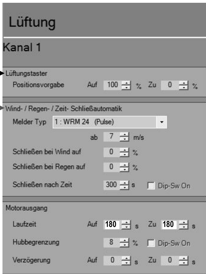
Abb.: Konfigurationsoberfläche Lüftung, Kanal 1
