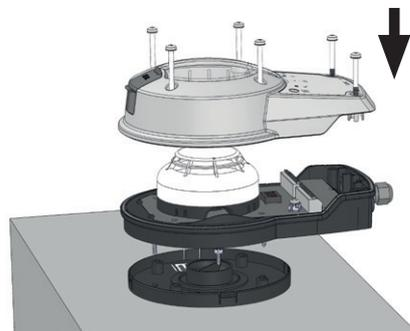
2. Durch Linksdrehen des weißen Melders auf dem Sockel um ca. 20° lässt sich der Melder abschrauben. Bei zu starker Verschmutzung (Anzeige > 70 %) sowie spätestens den nach Norm vorgeschriebenen Tauschzyklen, muss der Melder durch einen Austauschmelder ersetzt werden.
