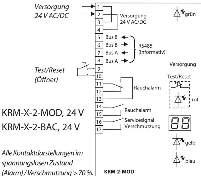
*Fern-Reset/-Test (Klemme 9+10): wenn Brücke entfernt wird, muss ein potentialfreier Öffner angeschlossen werden.*
